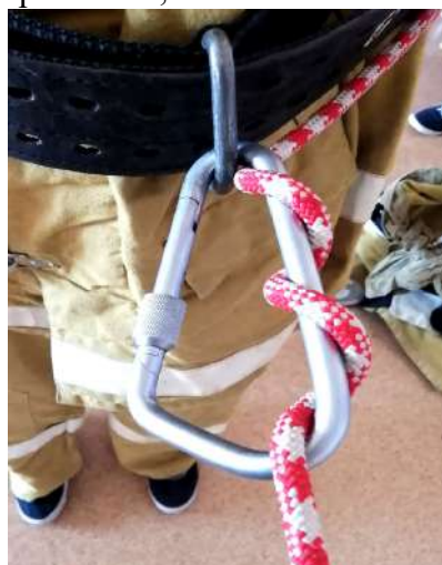
Закладка веревки в пожарный карабин: правильно, намотка «от себя»
