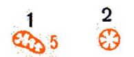
Ямы: 1) выражающиеся в масштабе карты (5—глубина в метрах); 2) не выражающиеся в масштабе карты
